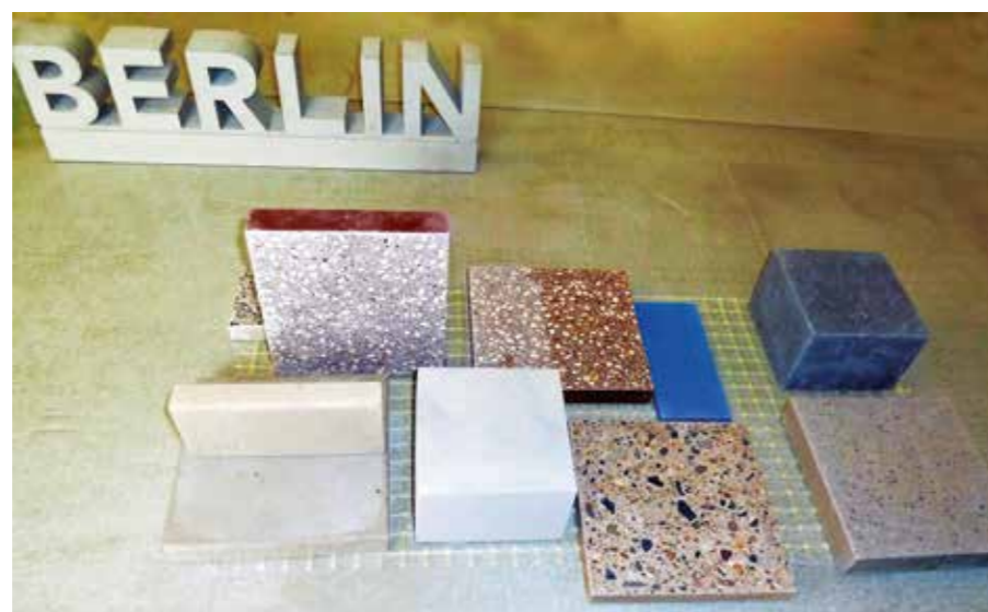
Das Bild zeigt Werkstücke, die mit dem neuen NaSiO-Binder gegossen wurden
