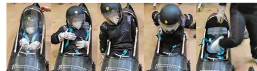
Bei der „Virtual Inspection“ mussten die Teammitglieder mittels Videos verschiedene Prüfungen wie zum Beispiel den Notausstieg aus dem Fahrzeug in weniger als zehn Sekunden demonstrieren
