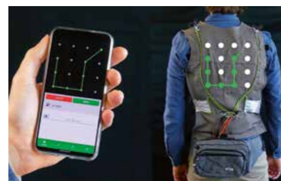
Im Rahmen von SUITCEYES wurde eine intelligente Weste entwickelt, die die Kommunikationsmöglichkeiten von taubblinden Menschen erweitert
