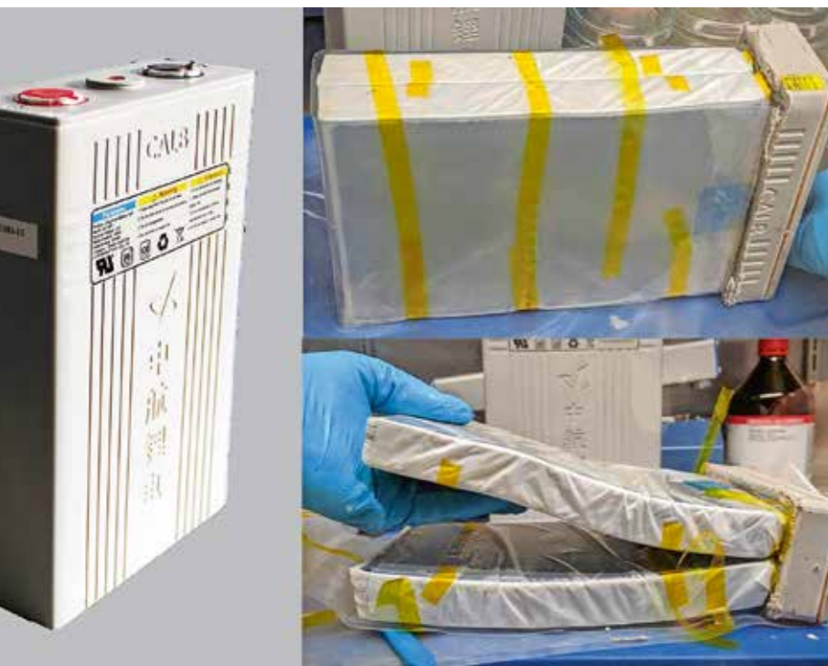
Eine Lithium-Ionen-Batteriezelle für Heimspeicher (links) wird im Batterielabor der Hochschule Offenburg geöffnet (rechts oben) und in ihre Bestandteile zerlegt (rechts unten)
