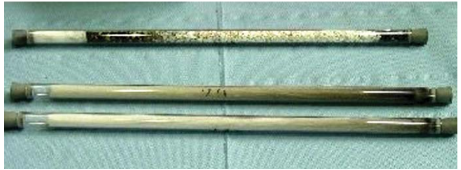
Abb. IV-14.2: Glasrohr mit Katalysatorfüllung (oben) sowie beladene Messrohre zur Teerbestimmung
