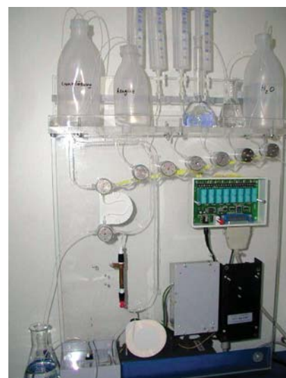
Abb. IV-13.1: Frontansicht der Schwerkraft-FIA mit sechs Probenschaltventilen (oben) und einer Injektionseinheit, bestehend aus zwei Ventilen (rechts). Links unterhalb der Reaktionsschleife ist der VIS-Detektor erkennbar. Das Reduktionsrohr ist zwischen der Probenschleife und der Reaktionsschleife zu sehen.
