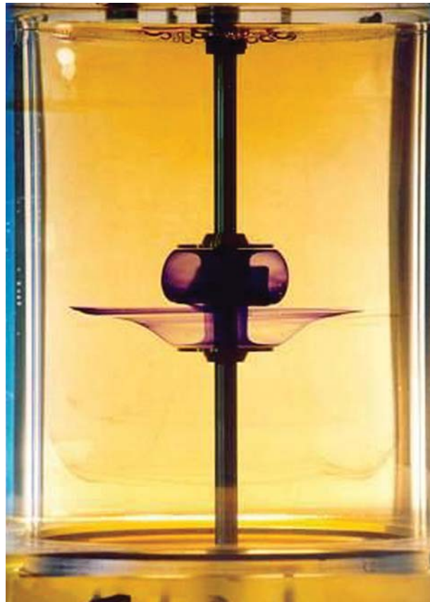
Abb. IV-12.3: Asymmetrische Sekundärströmung zwischen den Scheiben, Abstand h = 50 \text{ mm} , Reynoldszahl Re = \omega R^2/\nu = 3000
