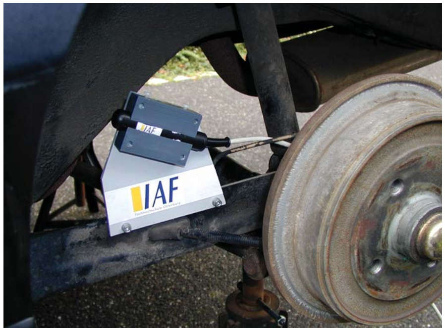
Abb. IV-4.2: Montage des Komplettsystems am Testfahrzeug
