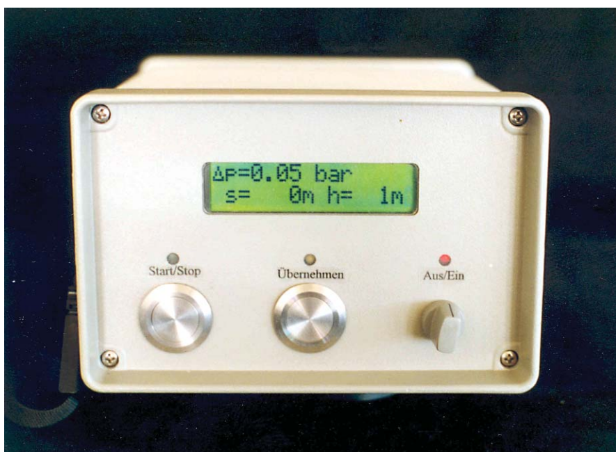
Abb. IV-9.1: „FloriBar“: Messung von Druckverlusten in Feuerwehrschräuchen
